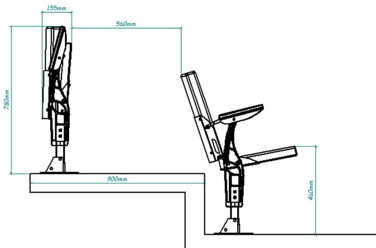
Ce siège a été spécialement étudié afin de garantir un confort optimal dans un espace relativement restreint tout en respectant l'article L28 de la réglementation des ERP.
